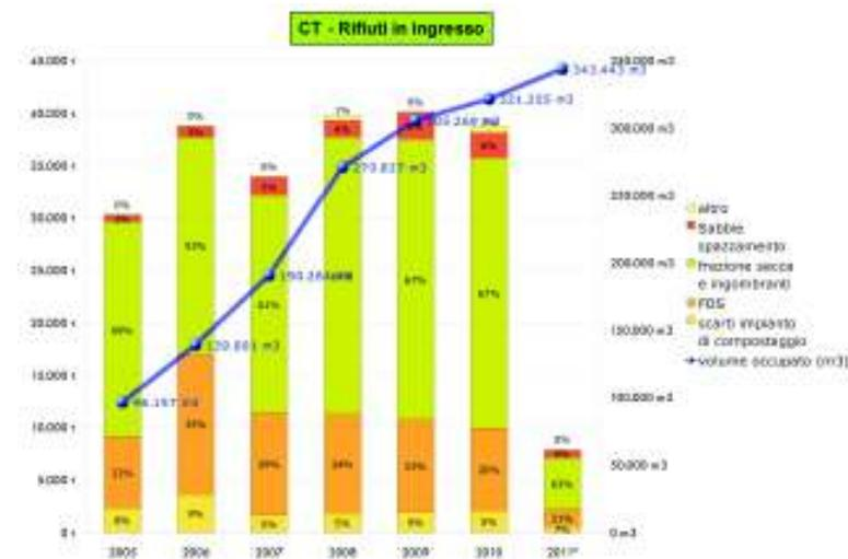
[Figura 23.]: quantità di rifiuti in ingresso alla discarica per rifiuti non pericolosi e volume occupato dai rifiuti. Nella categoria "altro" sono compresi gli pneumatici fuori uso e i rifiuti cimiteriali. La frazione secca comprende i rifiuti da trattamento meccanico e le macerie non contenenti sostanze pericolose. Dati aggiornati al 30/04/2011.
