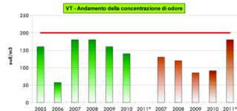
[Figura 51.]: Polo trattamento VT - Andamento nel tempo dei valori di concentrazione di odore in uscita dai biofiltri del tetto (in verde) e di quelli a terra (in marrone).
